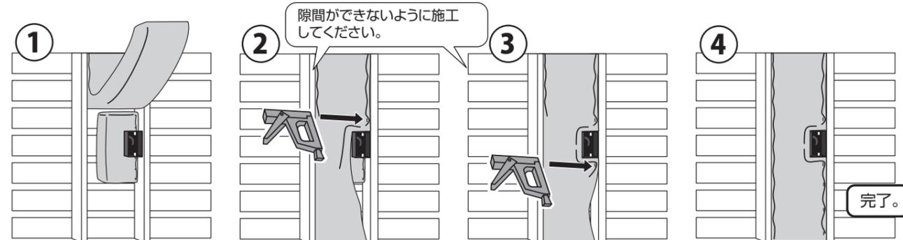
① コンセントボックスの裏側に小さくカットしたサーモールを充填しておきます。
