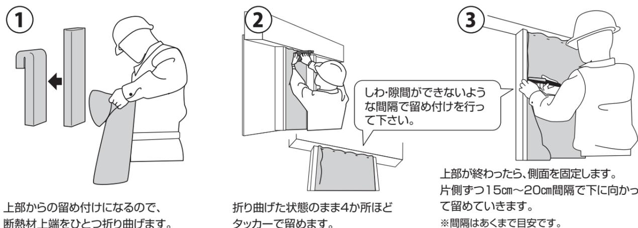
上部からの留め付けになるので、断熱材上端をひとつ折り曲げます。
