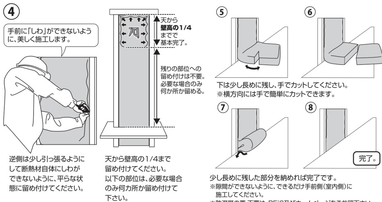
逆側は少し引っ張るようにして断熱材自体にしわができないように、平らな状態に留め付けてください。
